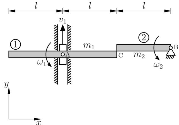
Stellen Sie die zur Lösung des Stoßproblems notwendige kinematische Beziehung zwischen den Größen  $v_1$  ( $\hat{=}$  Geschwindigkeit des Punktes A),  $\omega_1$  ( $\hat{=}$  Winkelgeschw. des Rotors) und  $\omega_2$  ( $\hat{=}$  Winkelgeschw. des Stabes) auf. **(1,0 Punkte)**
