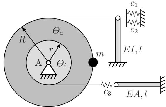
Berechnen Sie die Ersatzfedersteifigkeiten für die Gruppierungen, die am oberen ( $c_o$ ) und am unteren ( $c_u$ ) Seil befestigt sind. **(2,0 Punkte)**
