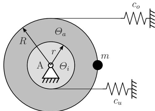
Zeichnen Sie zunächst einen geeigneten Freiheitsgrad zur Beschreibung von Eigenschwingungen um die dargestellte Lage ein. Geben Sie anschließend die kinetische  $E_{kin}$  und potentielle Energie  $E_{pot}$  des Systems als Funktion des von Ihnen gewählten Freiheitsgrades an. **(3,0 Punkte)**
