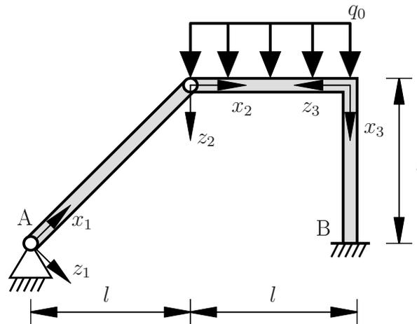
Zeichnen Sie das statisch bestimmte Ersatzsystem, welches sich ergibt, wenn die Einspannung in B durch ein Festlager sowie ein Moment  $X$  ersetzt wird. Geben Sie zudem die Kompatibilitätsbedingung an, welche sich im Lager B ergibt. Nutzen Sie dafür die vorgegebene Koordinate  $x_3$  für den rechten Rahmenabschnitt. Die zugehörige Biegelinie sei mit  $w_3(x_3)$  bezeichnet. **(1,0 Punkte)**
