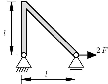
Bestimmen Sie die im dargestellten System gespeicherte Formänderungsenergie  $II$  in Abhängigkeit der gegebenen Größen. Beiträge aus Schubverformung sind zu vernachlässigen.
