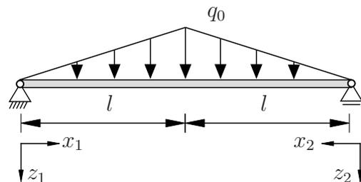
Berechnen Sie die Funktion der Biegelinie  $w_1(x_1)$  für  $0 \leq x_1 < l$  für das gegebene System inklusive der Bestimmung aller Integrationskonstanten. Tragen Sie die wichtigsten Zwischenschritte sowie das Ergebnis in das nachfolgende Kästchen ein. **(4,0 Punkte)**
