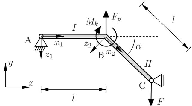
Geben Sie für den abgewinkelten Rahmen die Bedingungen zwischen den Schnittgrößen  $N$ ,  $Q$  und  $M$  am Übergang zwischen Bereich  $I$  und  $II$  in Punkt  $B$  an. **(2,5 Punkte)**
