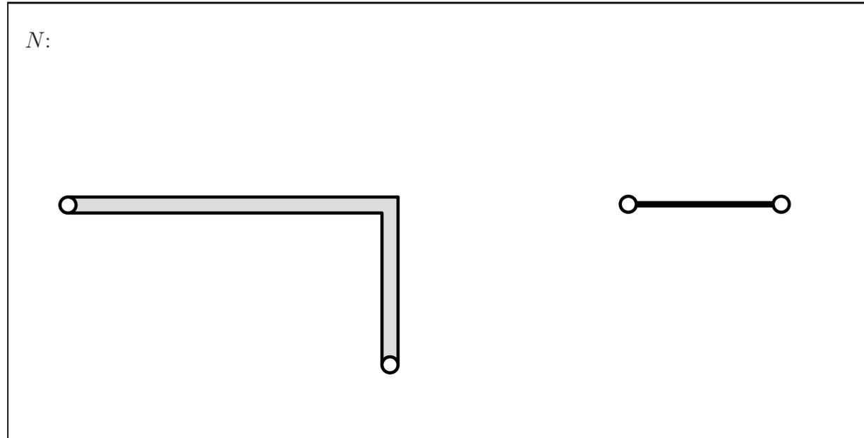
Zeichnen Sie den Biegemomentenverlauf  $M$  für den linken, rechtwinkligen Rahmen und den Stab. Geben Sie Rand- und Eckwerte sowie den Polynomgrad  $p$  an. **(2,5 Punkte)**
