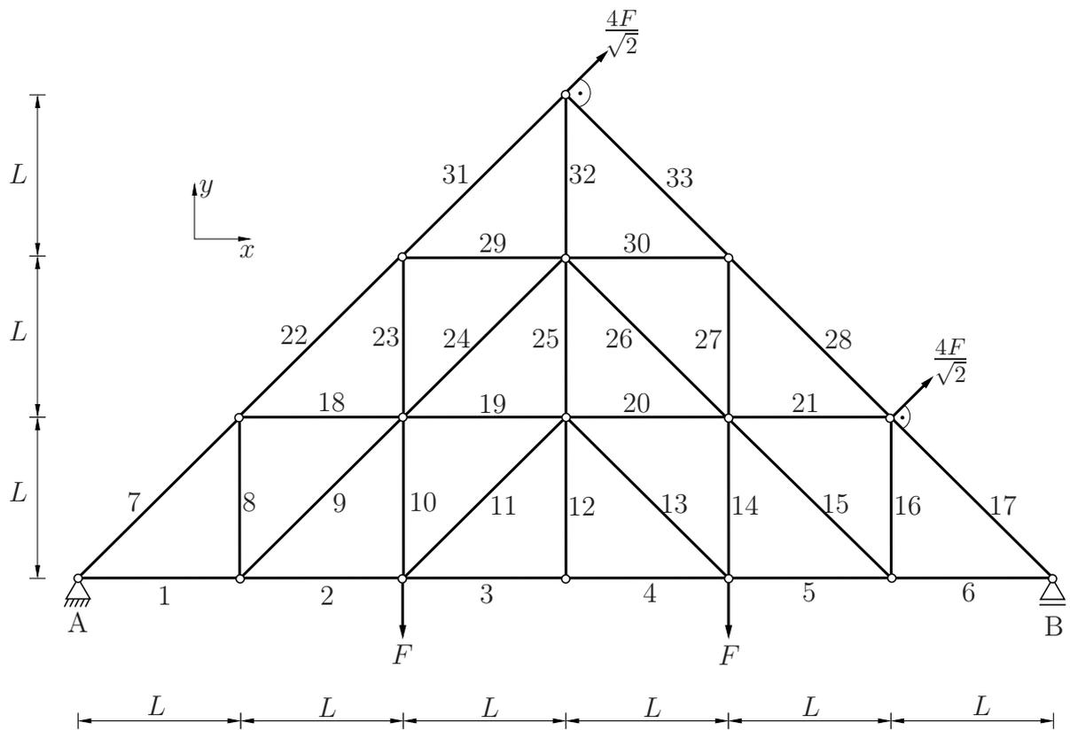
Berechnen Sie die Auflagerreaktionen in den Punkten A und B bezüglich der durch das vorgegebene Koordinatensystem positiv definierten Richtungen. **(3,0 Punkte)**
