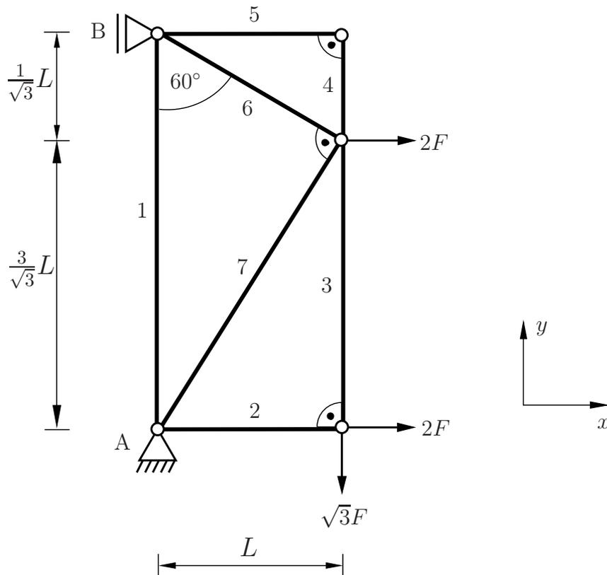
Geben Sie sämtliche Auflagerreaktionen sowie sämtliche Stabkräfte in Abhängigkeit von  $F$  als auch die Länge  $l_7$  des Diagonalstabes 7 an. Dabei gelte die Konvention, dass Zugkräfte positiv anzunehmen und die Auflagerkräfte positiv in positiver Koordinatenrichtung zu definieren sind. **(7,0 Punkte)**
