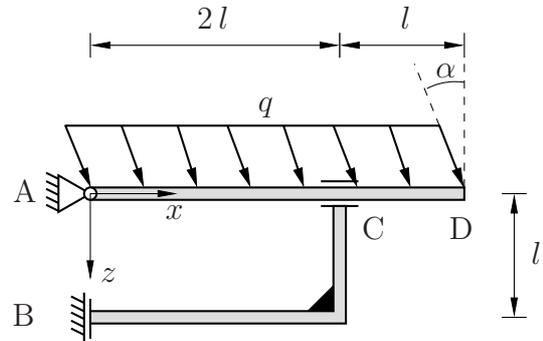
Zeichnen Sie qualitativ den Normalkraft-, Querkraft- und Momentenverlauf des horizontalen Trägers in Abhängigkeit des angegebenen Koordinatensystems. Geben Sie darüber hinaus den jeweiligen Polynomgrad  $p$  der Schnittgrößenfunktionen sowie die Werte der entsprechenden Schnittgrößen an den Punkten A, C und D an. **(6,0 Punkte)**
